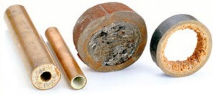
Dépôt calcaire dans une machine à laver ou dans une canalisation
