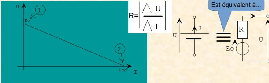
L'équation caractéristique d'une source réelle de tension:
