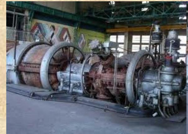
Quel que soit le type de centrale **l'élément qui assure le transfert d'énergie mécanique en énergie électrique est un alternateur.**
