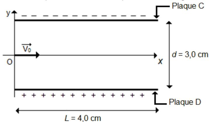
2.2. Dans un condensateur plan, le champ électrique  $E$  a une direction perpendiculaire aux plaques, et un sens orienté vers la plaque chargée négativement.
