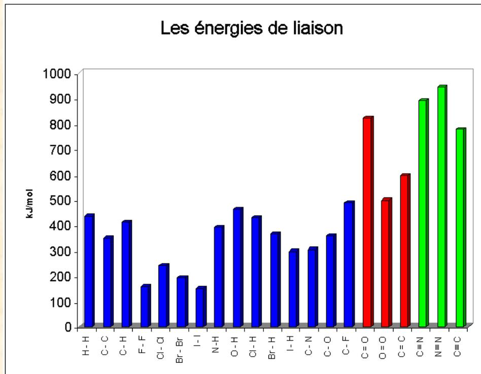
La combustion permet de récupérer de l'énergie parce que l'énergie qui est produite quand les réactifs sont consommés est supérieure à celle de construction des produits.
