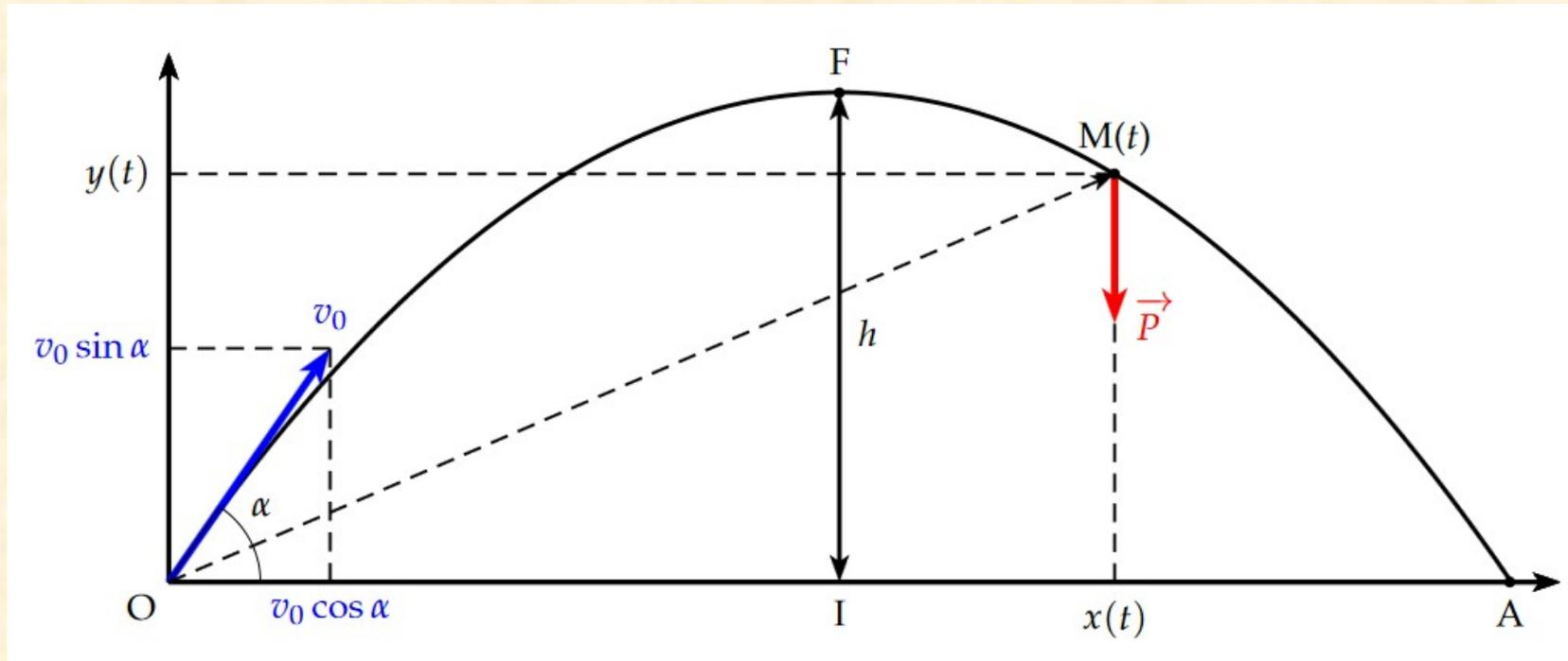
La trajectoire est une branche de parabole. L'angle de départ et la vitesse initiale Conditionnent la longueur du tir (**la portée A**) et la hauteur du tir (**la flèche A**)
